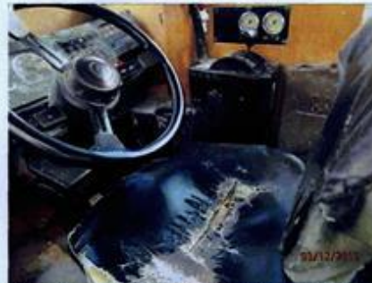
Imagen 24. Sillones en mal estado de maquinaria que se utiliza en mina.
