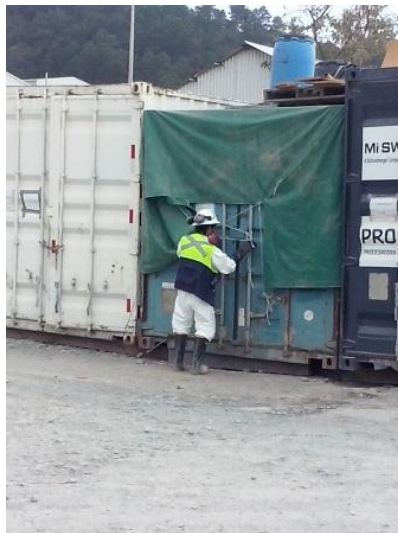
Imagen 73. Almacenamiento inadecuado para guardar los químicos utilizados en la producción. Imagen 74. EPP inadecuado que se utiliza para el manejo del cianuro.
