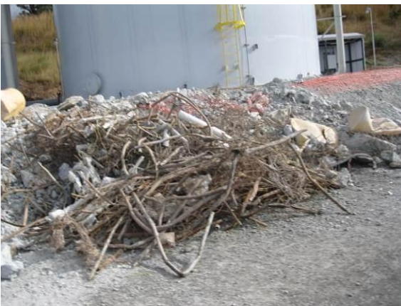
Imagen 32. Chatarra que se retira del mineral previo a entrar a la trituradora primaria.
