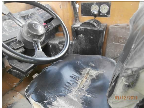
Imagen 24. Sillones en mal estado de maquinaria que se utiliza en mina.
