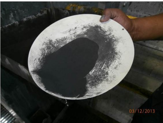
Imagen 42. Concentrado de plomo luego del proceso de flotación.
