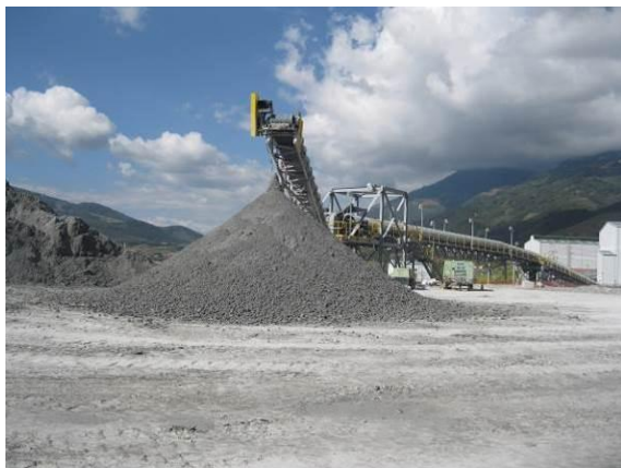
Imagen 25. Caída de material en el área de stacker.
