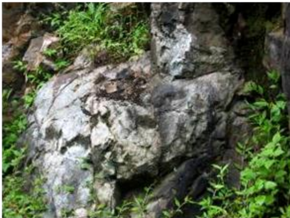
Figura 8.18 Sitio 5 de mediciones estructurales en andesitas. El fracturamiento sigue con tendencia a ser perpendicular y conjugado. Marcadamente bimodal, con el patrón dominante orientado N155 y el subordinado al N085. Los buzamientos en este afloramiento predominan al SWW (N250) y los otros se distribuyen casi N-S (ver roseta de buzamientos –dip direction–).
