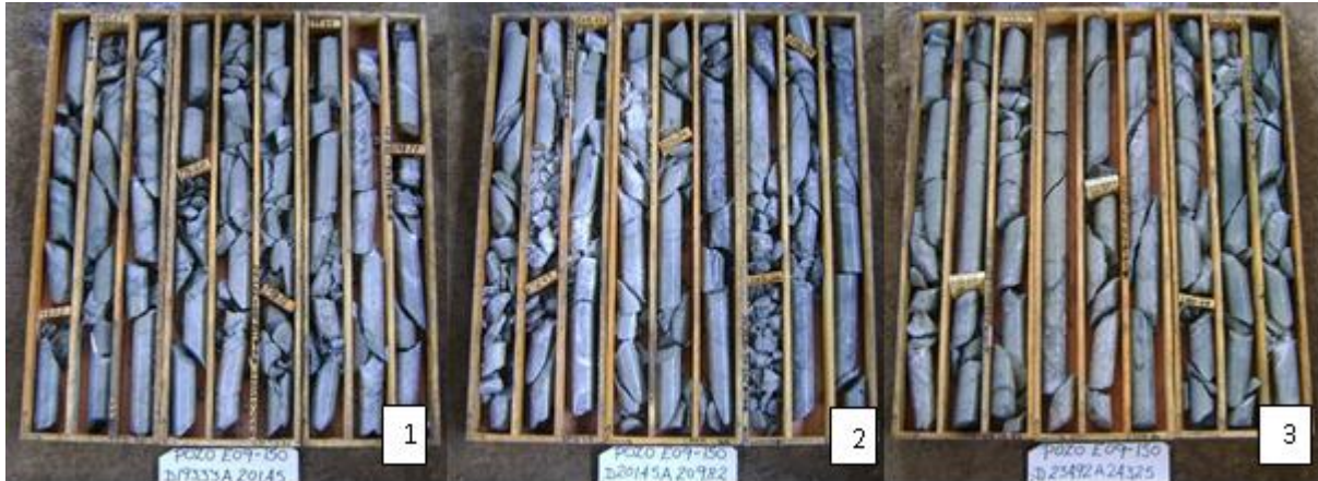
Figura 8.22 Pozo E09-150 Perfil E806450 (Veta 210m. a 227 m.) 1 Techo (roca encajadora), 2 Mineralización y 3 Piso (Roca encajadora)
